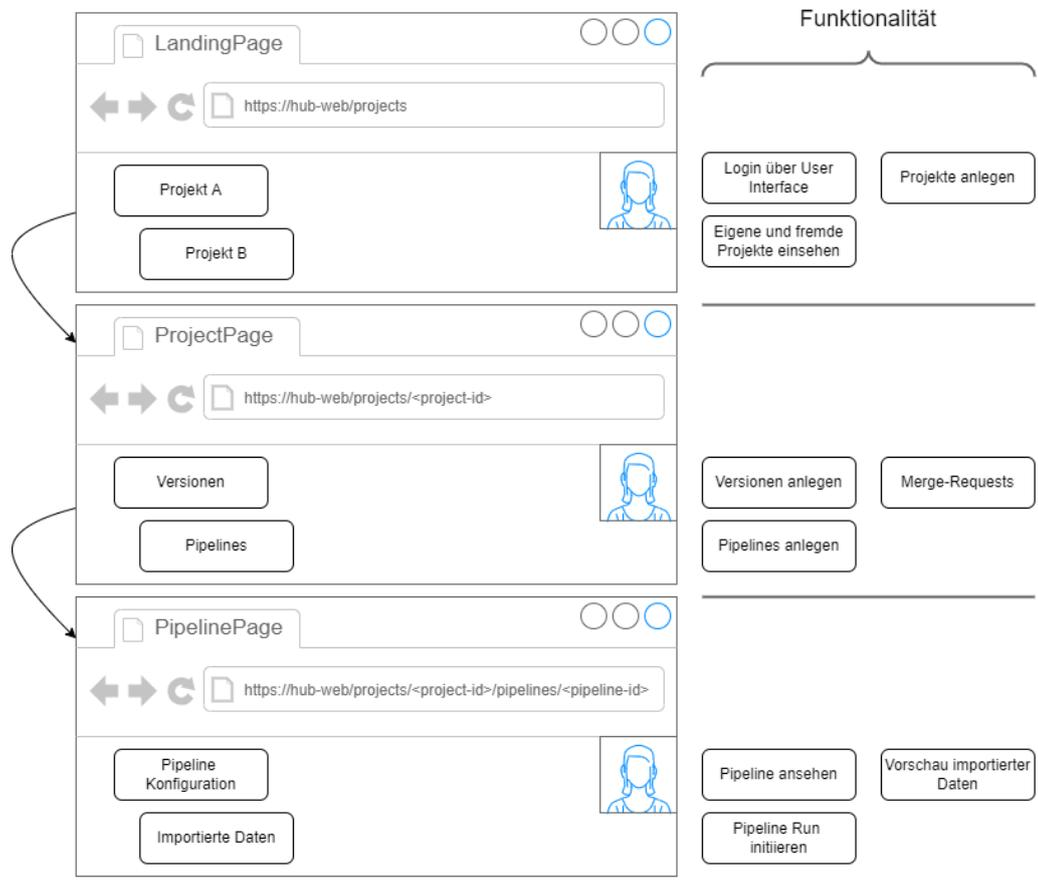
**Abbildung A6:** Vereinfachtes User Flow Diagramm des Frontends Hub-Web. Es zeigt den User Flow vom Aufruf der LandingPage bis zum Anlegen und Ausführen einer ETL-Pipeline.
